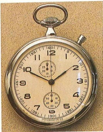
Die „28-ЧК“ aus der 2. Moskauer (Bild 172) hat das „Molnia“-Taschenuhrwerk (Bild 173) als Basiskaliber.
